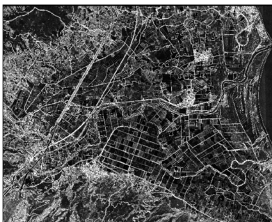
Εικ. 15. Αποτέλεσμα εφαρμογής φίλτρου τυπικής απόκλισης στο δείκτη NDVI.
