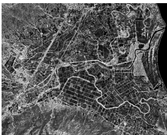
Εικ. 14. Αποτέλεσμα εφαρμογής φίλτρου τυπικής απόκλισης στο κανάλι 7.
